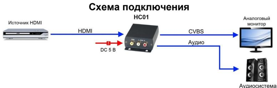
Рис.3 Схема подключения HC01
